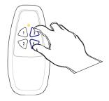
Per escludere il sensore sole premere i tasti di destra della trasmittente
